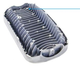
DIE-CAST AFTER MACHINING ON **BROTHER 650** MACHINE TOOL
